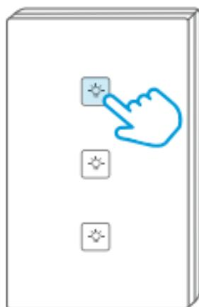
*Los switches permanecerán iluminados en color rojo cuando el apagador esté en reposo. Cuando el foco conectado esté encendido, el switch correspondiente se iluminará en azul.*
